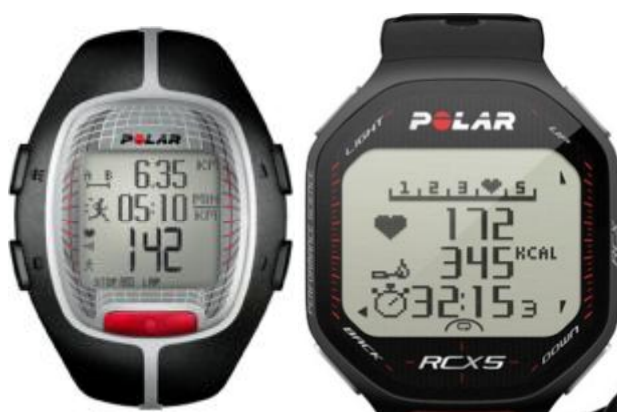
Рисунок 6 – Дисплей приемника – монитора сердечного ритма. Пример отображаемых параметров тренировки
