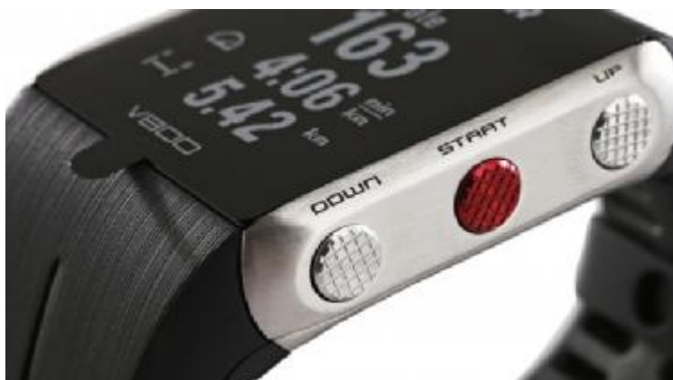
Рисунок 3 – Дисплей приемника – монитора сердечного ритма. Расположение базовых кнопок
